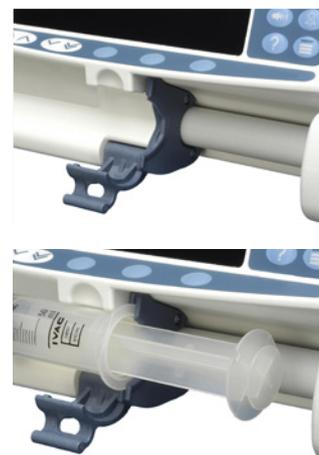
4. 提起注射器夹直至其锁定注射筒。
