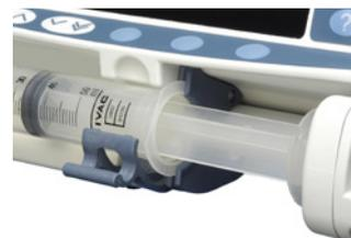
5. 将柱塞杆上的指套挤压在一起并将此装置滑至左侧，直至其到达柱塞末端。
